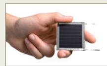
Erstes Minimodul aus CuInS 2 am Hahn-Meitner-Institut mit 10 % Wirkungsgrad
