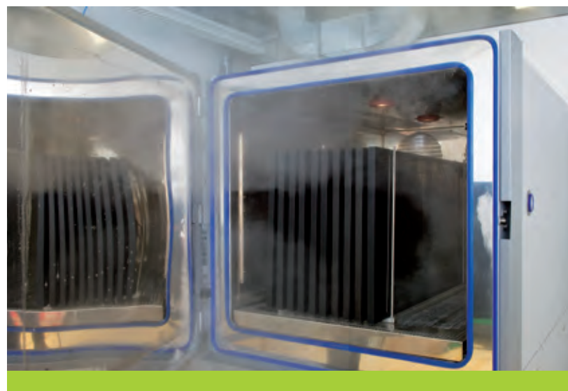
Sulfurcells Klimakammer zur beschleunigten Modulalterung
