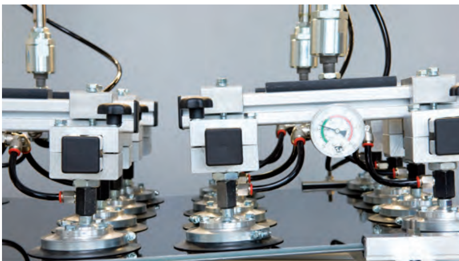
Test de torsion Sulfurcell pour modules sans cadre
