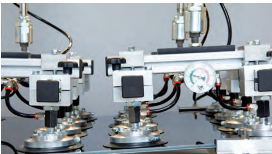
Il test di svergolamento condotto da Sulfurcell sui moduli senza telaio
